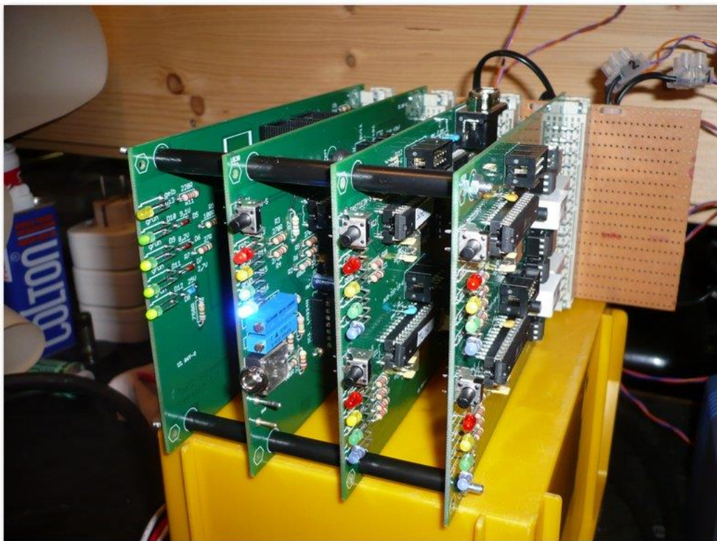
Abbildung 1: Musteraufbau des i-Telex mit „handgemachter“ Busplatine
